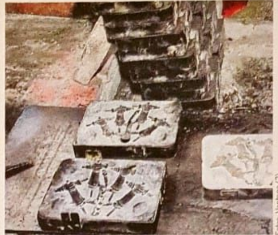
Das Metall fließt in die Hohlräume, die durch Abdrücke entstanden sind. Jede Form ist nur einmal zu gebrauchen.
