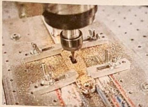
Mit einer CNC-Fräse werden Schlüsseloch und Bohrlöcher genau an Türen und Fenster angepasst.
