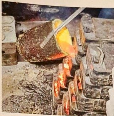
Das heiße Messing, eine Legierung aus Kupfer und Zink, gießen die Arbeiter in die mit Sand gefüllten Formen.
